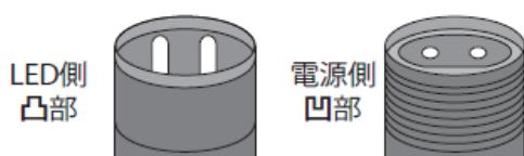
LED側凸部と電源側凹部をしっかりと差込みます。
